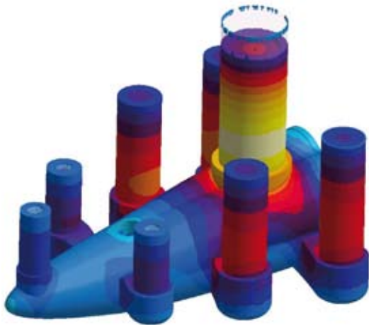
Die simulierten Erstarrungszeiten des Gussknotens zeigen eine gerichtete Erstarrung zu den Speisern hin
