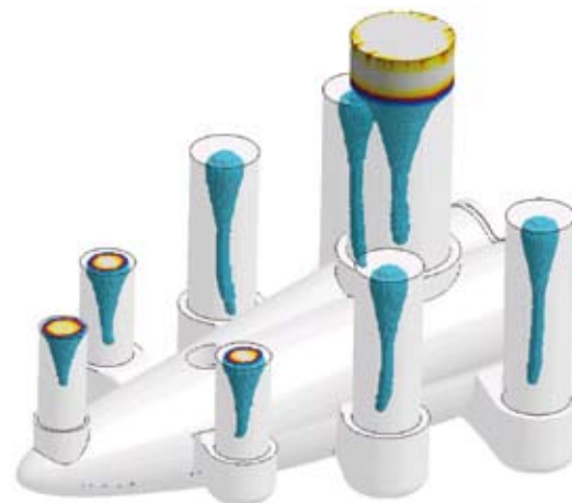
Mit dem optimierten Speisungssystem traten im Gussknoten keine Porositäten mehr auf
