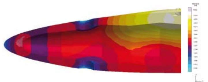
Erste Auslegung der Gießtechnik am Rohteil führte zu einer Gießverstärkung am Gussknoten
